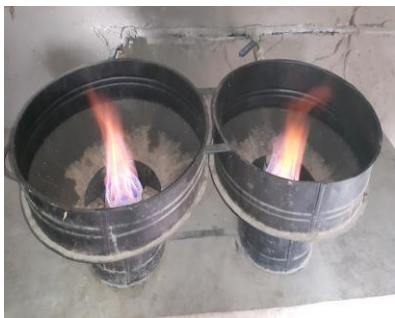
Photo 01 : Réchaud double feu modèle PNB-SN
